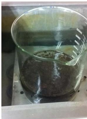
**Figura 13:** El proceso de hidrólisis enzimática, en baño maría a temperatura constante a 40°C.
