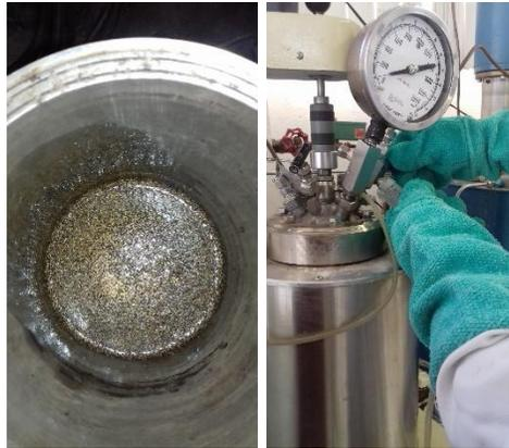
**Figura 10:** Reactor PARR de 2000 ml donde se llevó acabo la hidrólisis ácida.
