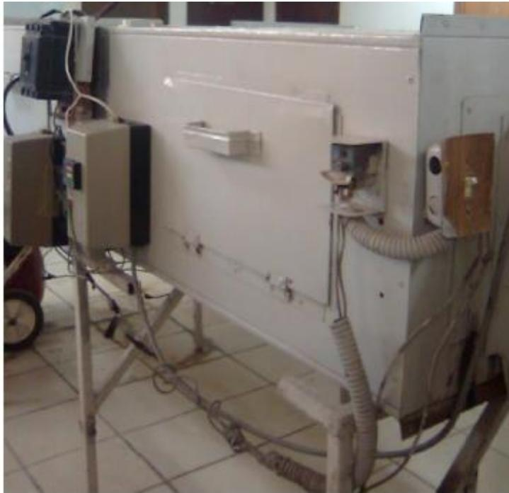
**Figura 8:** Horno de secado con convección de aire
