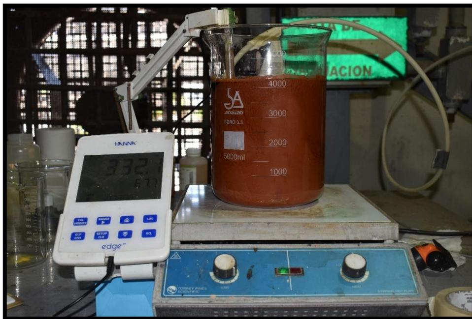
Otro método frecuente en el ajuste del pH consiste en la adición de ácido o base a una solución para disminuir o aumentar el pH, respectivamente. En esta etapa visualmente muy descriptiva, se realiza un seguimiento constante del pH mientras se agregan pequeñas cantidades de reactivo para alcanzar el valor deseado.
