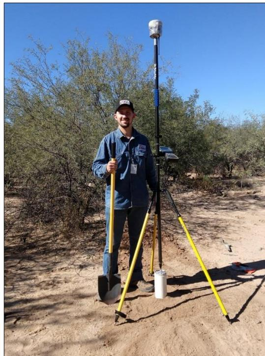
**Fotografía 17. Colocación y levantamiento de coordenadas de mojenera**
