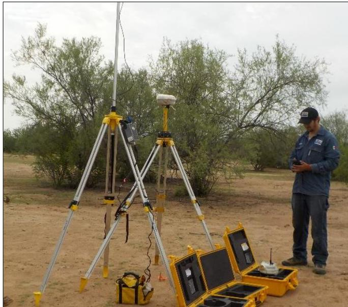
Fotografía 5. Radio (izquierda) y estación base (derecha)
