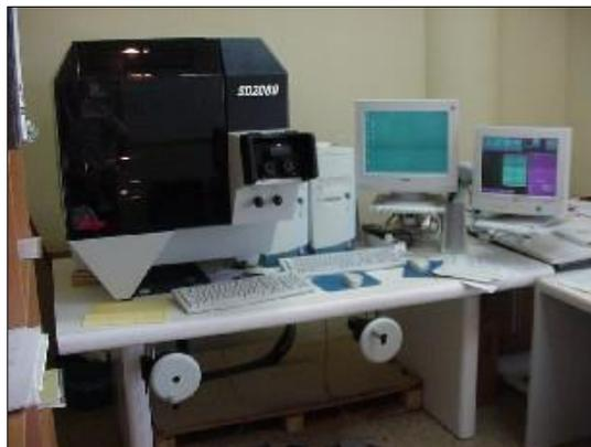
**Fotografía 3. Restituidor analítico**
