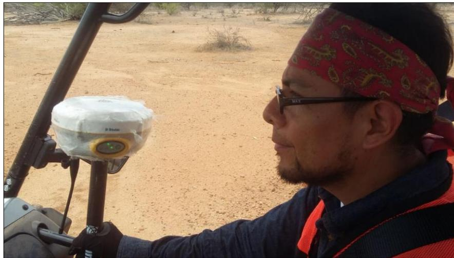
**Fotografía 13. Receptor móvil fijado al vehículo**
