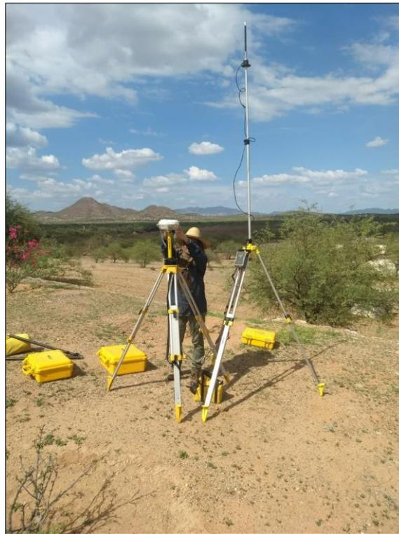
**Fotografía 9. Establecimiento de punto base topográfico**
