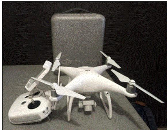
Fotografía 18. Dron DJI Phantom 4
