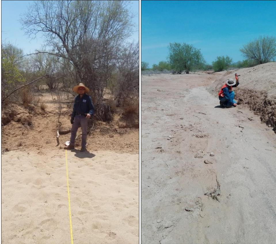
**Fotografía 16. Medición de ancho y alto de cauces**
