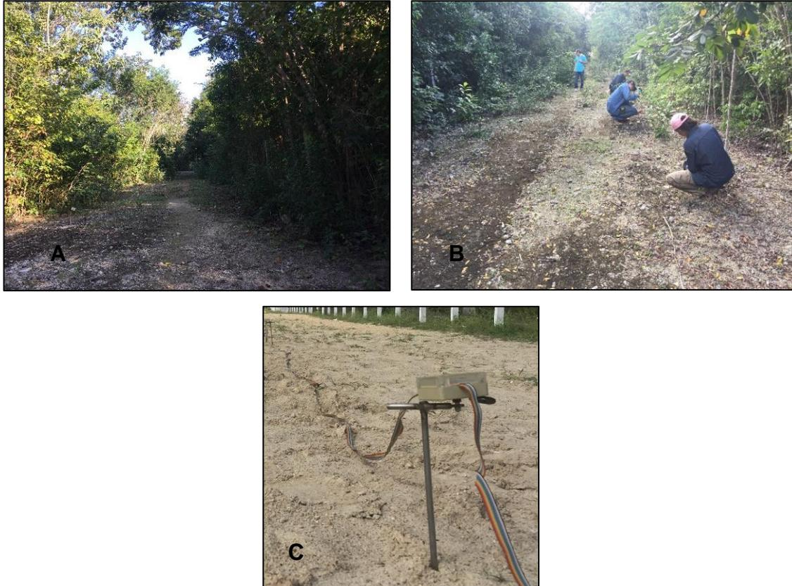
**Fotografía 5.** Trabajo realizado en campo A) Ubicación de zonas para realizar las secciones B) Colocación de estacas C) Electrodo en contacto con el suelo mediante estacas
