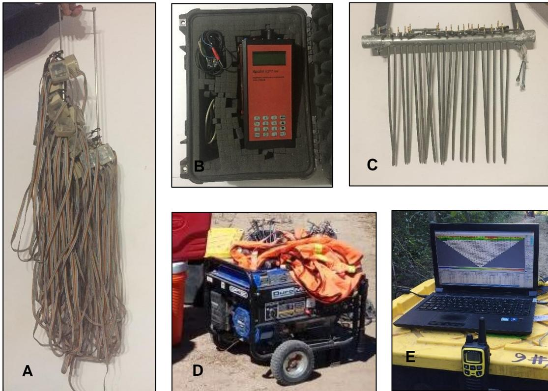
**Fotografía 4.** Equipo utilizado A) Cadenas de electrodos B) Resistímetro C) Estacas de acero D) Planta de electricidad E) Computadora
