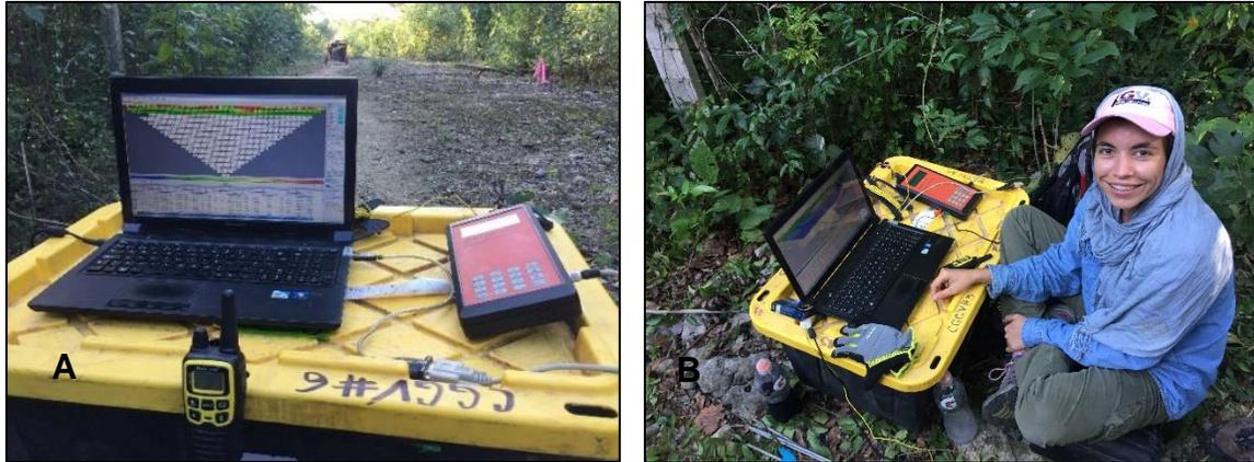
**Fotografía 6.** Adquisición de datos A) Resistímetro y software utilizado para la adquisición de datos B) Proceso de adquisición de datos
