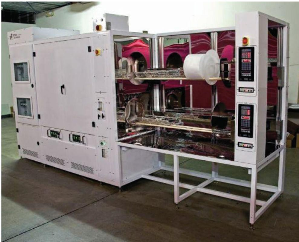
**Figura 4.1 - Equipo utilizado para la fabricación de las muestras de SRO (LPCVD) localizado en INAOE.**
