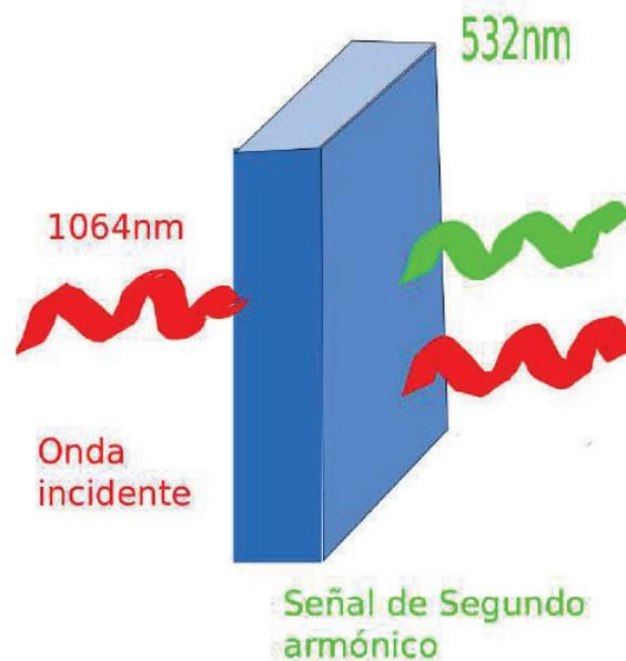
**Figura 4.1:** Descripción del proceso de segundo armónico.
