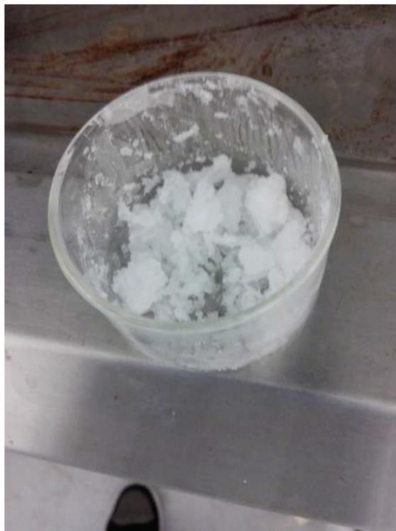
**Figura 5.6:** muestra 1. Glicina-Nitrato de sodio,  $100\text{mL}$  con  $0.01\text{mL}$  de nanopartículas de plata.
