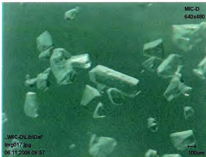
Figura 7. Imagen de microscopía óptica de un monocristal de GSN
