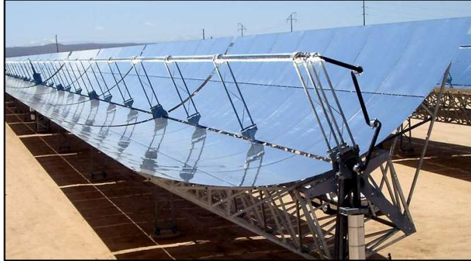
Figura 2. Sistema de canal parabólico.
