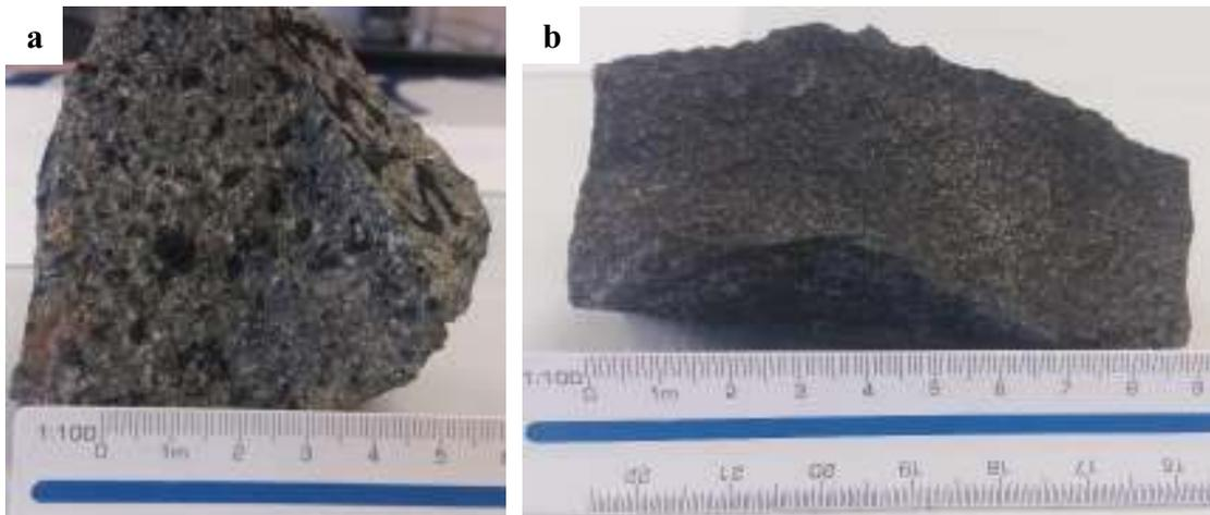
**Figura 42.** Muestras de mano del intrusivo de hornblenda de textura porfídica (a) y de un dique lamprofídico de textura panidiomórfica (b).
