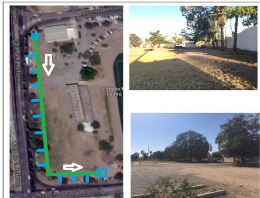
Fig. 161 Eje del trazo canal de conducción del agua, pozos absorción, y caja entrada y salida
