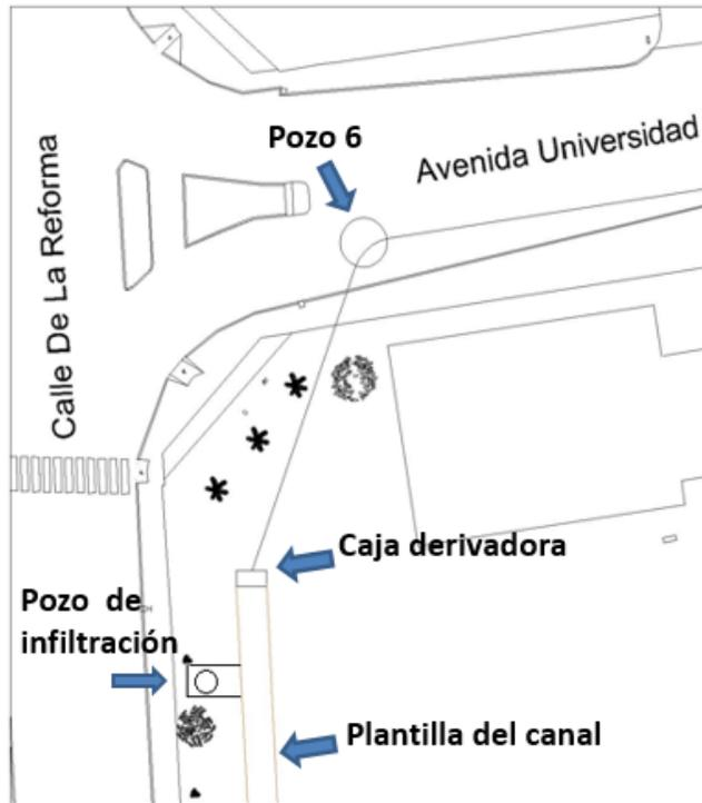
Fig. 15 Tramo pozo final del sistema pluvial y caja derivadora
