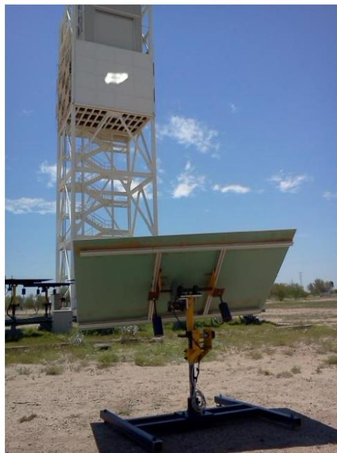
**Figura 4.10.** Prueba de mancha solar en tiempo real.
