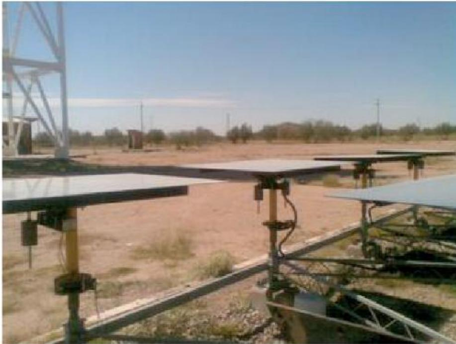
**Figura 4.3.** Helióstato en Posición de Reposo.
