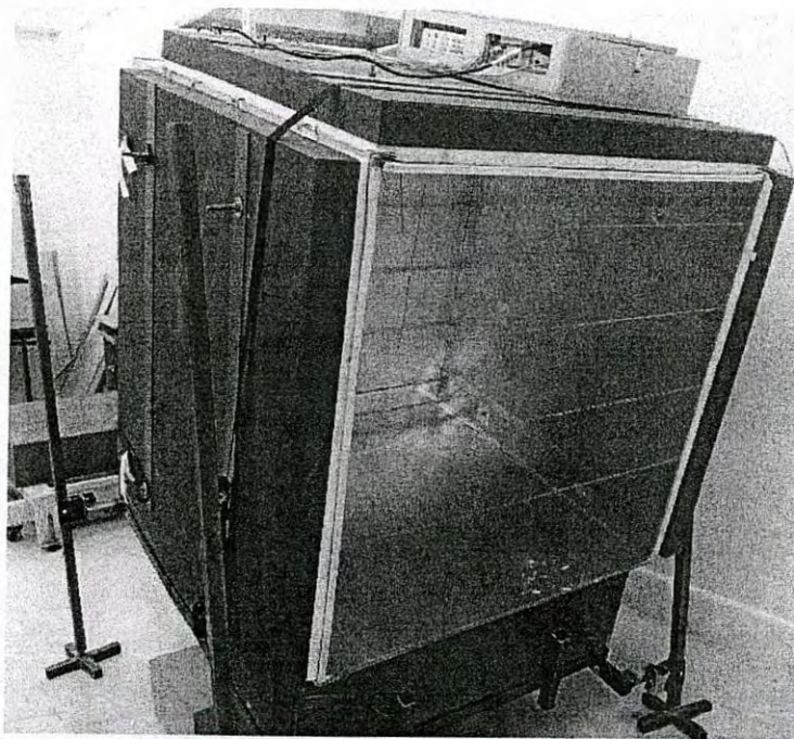
Figura 3.2 Cavity experimental con paredes de aluminio pulido.
