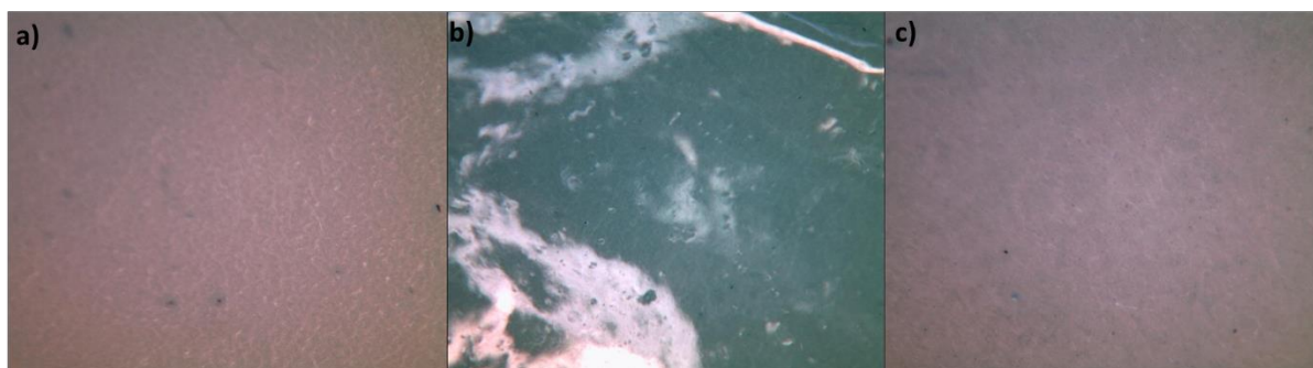
Figura 9. Morfología de la superficie de las películas formuladas a una magnificación de 2.5x: (a) Agar, (b) Quitosano, (c) Q+A.
