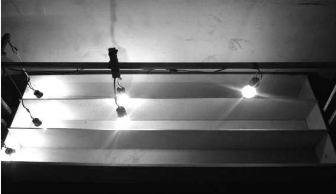
Figura 7. Caja experimental (15 x 60 x 20 cm), donde se creó un gradiente de temperatura de 20 °C (extremo derecho) a 50 °C (extremo izquierdo)
